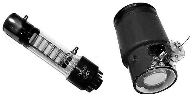
Рис. 6. Фотоэлектронные приборы с внешним фотоэффектом.
