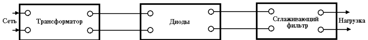
Рис. 1. Блок – схема выпрямителя.
