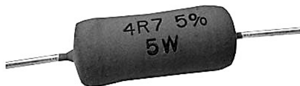
Рис. 7. Маркировка параметров на резисторе.
