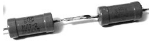
Рис. 19. Последовательное соединение резисторов.
